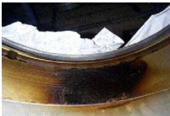
Рис. 2. Фотография изношенного подшипника с отчетливо заметным лаковым слоем
