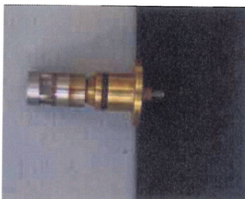
Рисунок - 2 Клапан системы регулирования со следами лакового слоя
