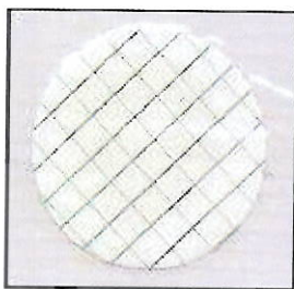
Рисунок 10 – Сравнительный анализ чистоты масла, проведенный на мембране с размером пор 0,4 мкм
